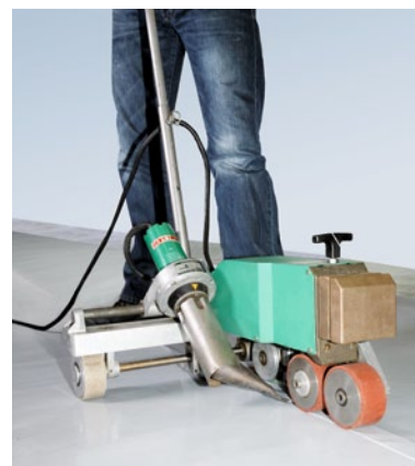
Schweißen mit der Heißluft-Schweißmaschine
